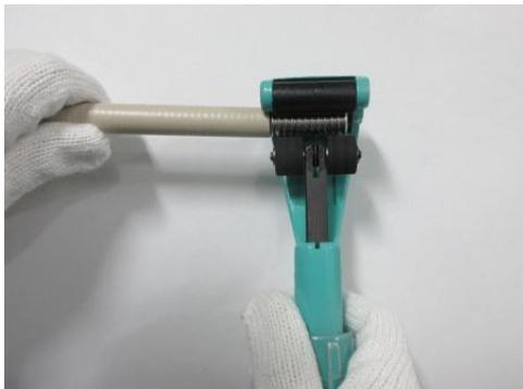
フレキカッターで原管を7山残して切断する。
