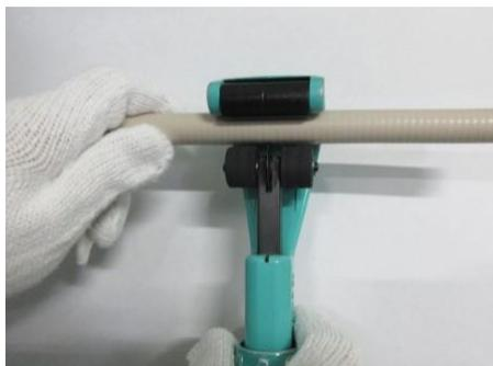
フレキ管を適当な長さに専用のカッター※を使用して切断する。
